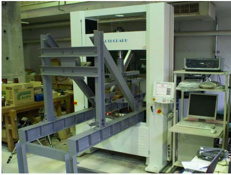
写真-5 静的加力実験装置
