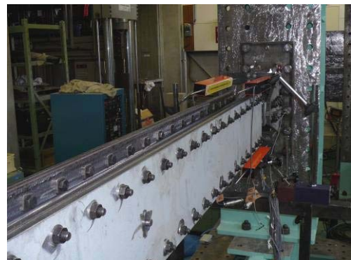
図-4 座屈拘束ブレース供試体概念図(左)と実験状況(右)
